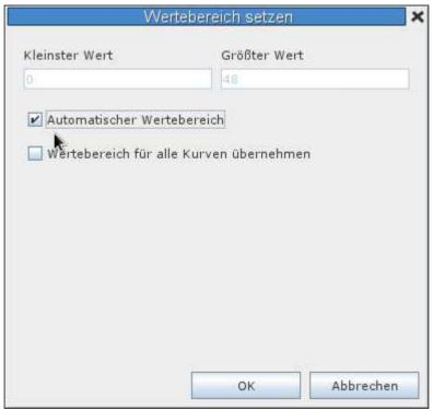
Wir klicken in der Checkbox "Automatischer Wertebereich" den Haken weg, tragen je einen passenden Wert bei "Kleinster Wert" und "Größter Wert" ein und klicken einen Haken in die Checkbox zu "Wertebereich für alle Kurven übernehmen". Im Beispielfall sieht das Fenster nun so aus:
